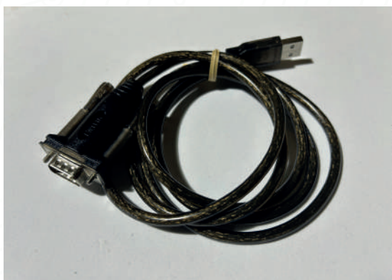
Figura 2 Conversor RS232-USB-DB9 macho-fêmea.
